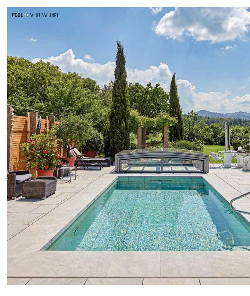
Auf der dem Einstieg gegenüberliegenden Seite ist die Turbinenschwimmanlage integriert. Gut zu sehen ist auch, dass die Niedrigüberdachung ohne Bodenschienen fährt und damit die Optik der hellen Feinsteinzeugumrandung optimal zur Geltung kommt.
